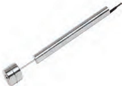
直流浮球式液位传感器具有优良的性能，采用方便的单电源9-28V DC供电，电子电路密封在304不锈钢金属管内，可以在潮湿和灰尘等恶劣环境中工作，输出信号为标准的可被计算机或PLC使用的0-5V，0-10V，Modbus RTU9600 RS485接口输出，4-20mA输出。
